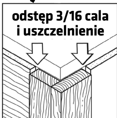
Widok narożnika zewnętrznego pasa dolnego
