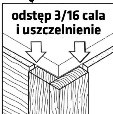
Widok narożnika zewnętrznego pasa dolnego
