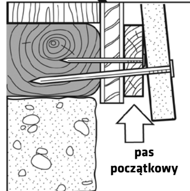
Widok szczegółowy pasa dolnego
