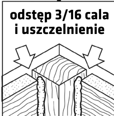
Widok narożnika wewnętrznego pasa dolnego
