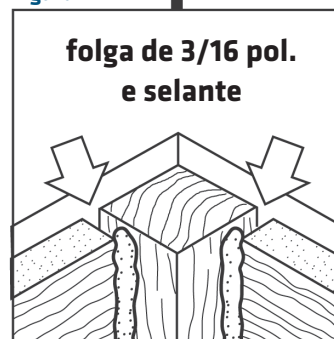
canto interno detalhe
